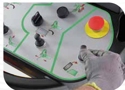
Palanca de mandos del elevador de rueda TOP
