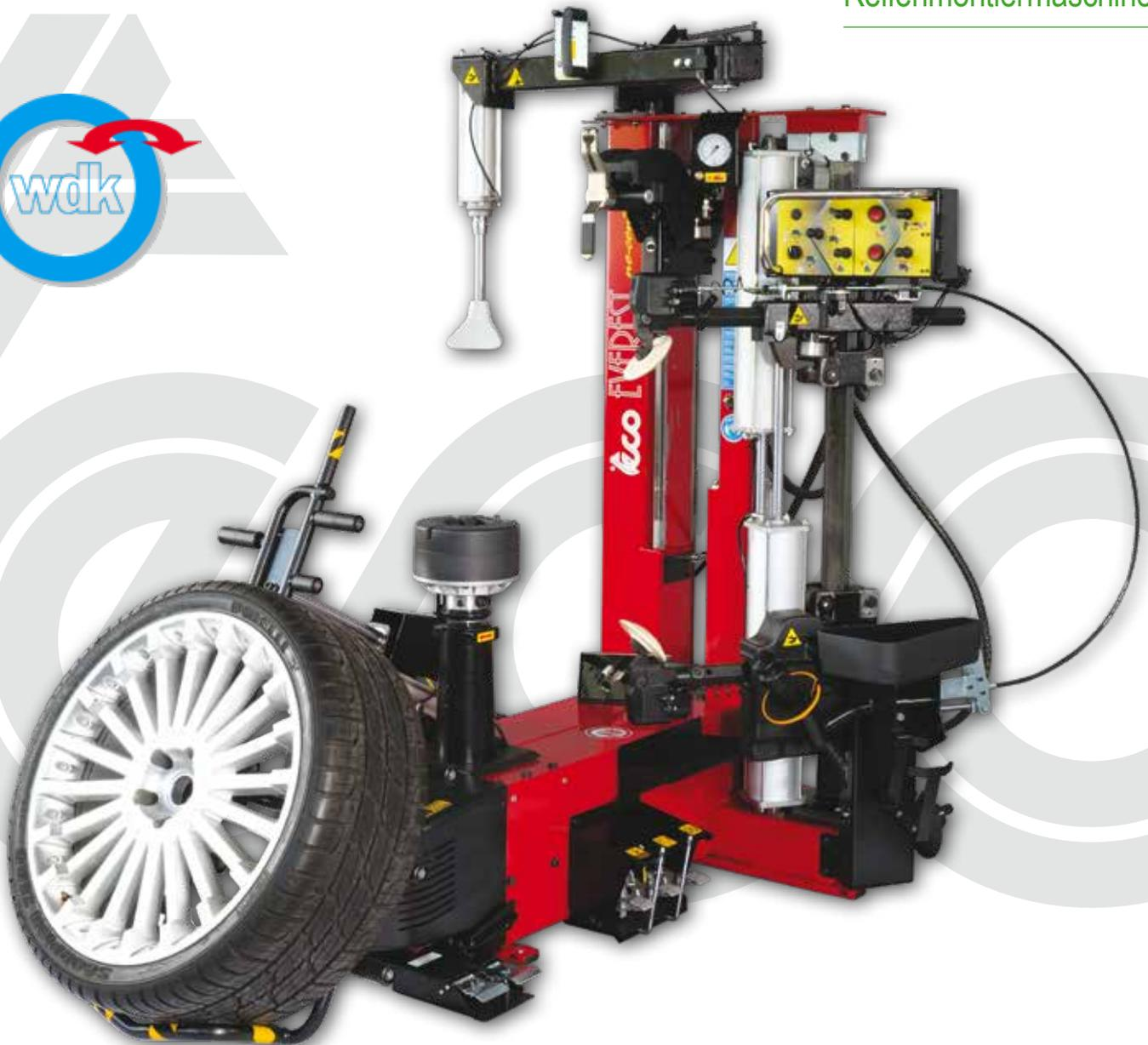
Vollautomatische Reifenmontiermaschine mit Technologie LEVERLESS / CONTACTLESS
